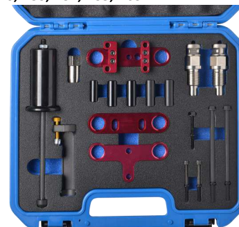
Orodje za razstavljanje in montažo injektorjev BMW N20, N53, N54, N55, N63
